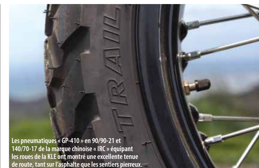
À l'instar de la KLE500 originelle, la nouvelle version est équipée de jantes à rayons de 21" à l'avant et 17" à l'arrière, renforçant son caractère baroudeur.
